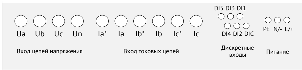
Рисунок 1.13. Расположение клемм ЭНИП-2-...-X3
