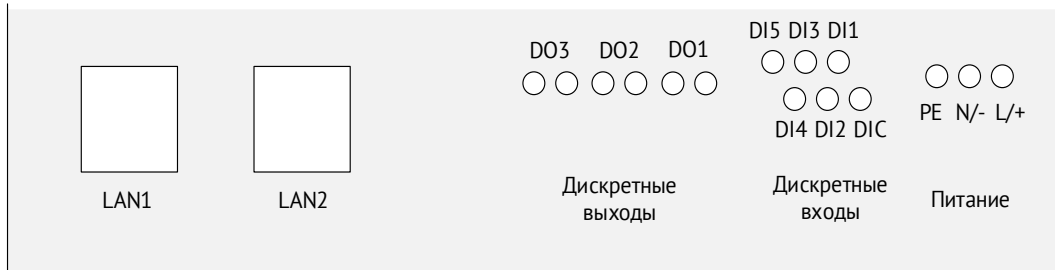
Рисунок 1.14. Расположение клемм и интерфейсов ЭНИП-2-0-...-X3
